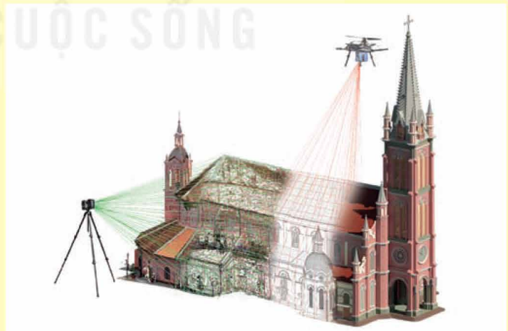
Sử dụng quét tia laser 3D trong mô hình hoá công trình kiến trúc (3)
